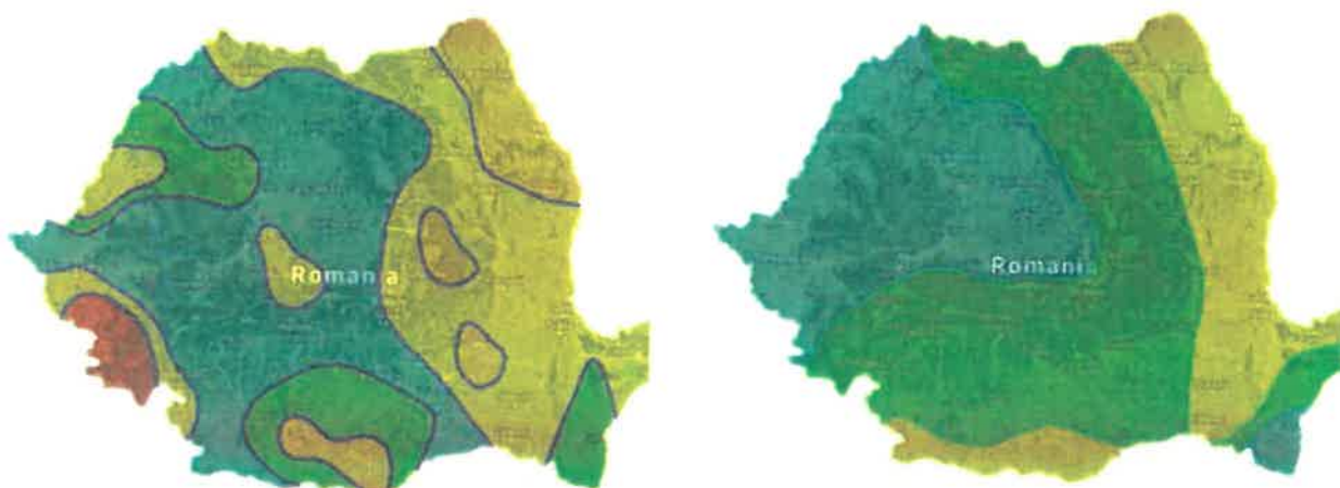
Figura 2 – Hartă de zonare în termeni de valori de referință ale presiunii dinamice a vântului (stânga) și Hartă de zonare în termeni de valori caracteristice ale încărcării din zăpadă pe sol (dreapta)
